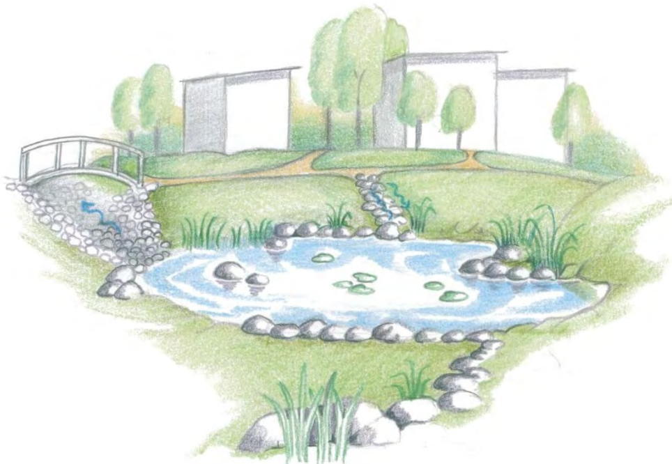
Kuva 10: Maanpäällisen hulevesipainanteen periaatekuva. Kuva: Ramboll.
