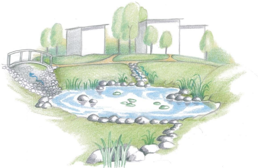
Kuva 10: Maanpäällisen hulevesipainanteen periaatekuva. Kuva: Ramboll.
