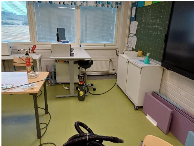
Kuva 33 Merkkiaineekaasun johtamista tilan 028 ulkoseinärakenteeseen Kuva 34 Tilan 028 ulkoseinästä havaittiin ilmavuotoa
